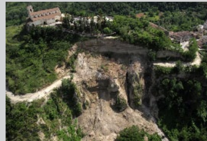
Castrovillari (CS) Aerofotogrammetria di una frana realizzata a fini di rilievo. Comune di Castrovillari - Università della Calabria
