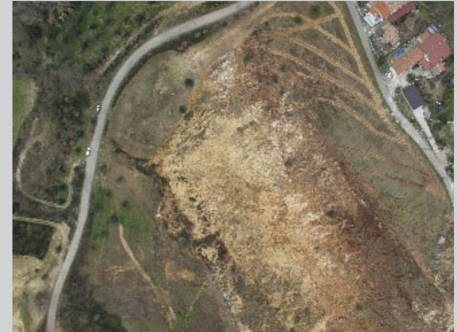
Montalto Uffugo (CS) Modello fotogrammetrico 3D di un corpo di frana realizzato a fini di monitoraggio. A destra uno degli scatti fotogrammetrici eseguiti da un'altitudine di circa 140 mt.
